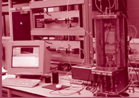
Opstelling triaxiaalproef in het laboratorium
